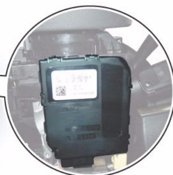
centralina per elettronica piantone sterzo J527, sotto la leva di comando sullo sterzo
